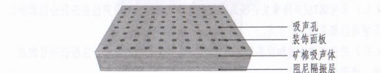
图3.1.2 ZS-XB型BKT吸声降噪复合板构造
